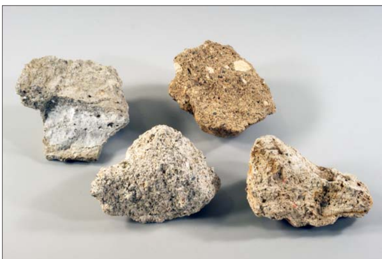
Figur 2. Exempel på olika murbruksvarianter som förekommer i kv Rosen. Från vänster syns ett cementbruk (O), ett magert kalkbruk (L), ett lerbruk (N) samt ett fett kalkbruk (G). Foto Lasse Norr, ÖM.
