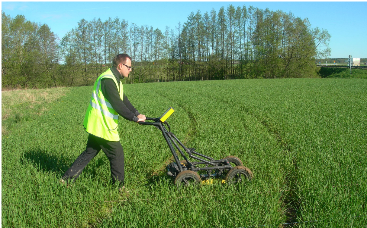
Figur 6. Georadarsystemet har vissa likheter med en barnvagn. Radarantennen är monterad omedelbart ovanför markytan på en glidplatta. På kontroll- och datauppteckningsenheten framför operatören visas vertikala profildata och viktiga mätparameter. För positionering av mätdata längst profillinjen finns ett distanshjul monterat på ett av vagnens hjul. Systemet körs längs med 50 m långa parallella profilsnören över undersökningsområdet.
