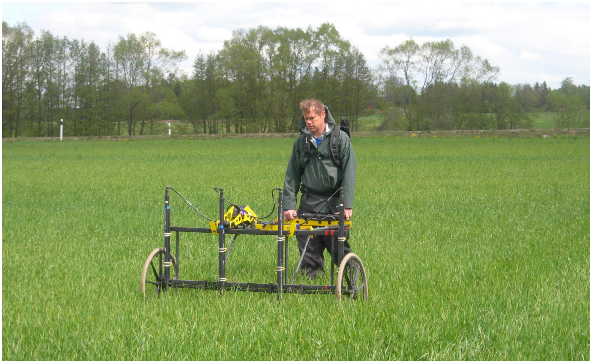
Figur 7. Magnetometersystemet bestående av fyra Förster gradiometerinstrument monterad med 50 cm mellanrum på en omagnetisk vagn. Vagnen förs längs 50 m långa mätprofiler över undersöknings-området. Mätpunktavstånd i profilriktningen är 10 cm.
