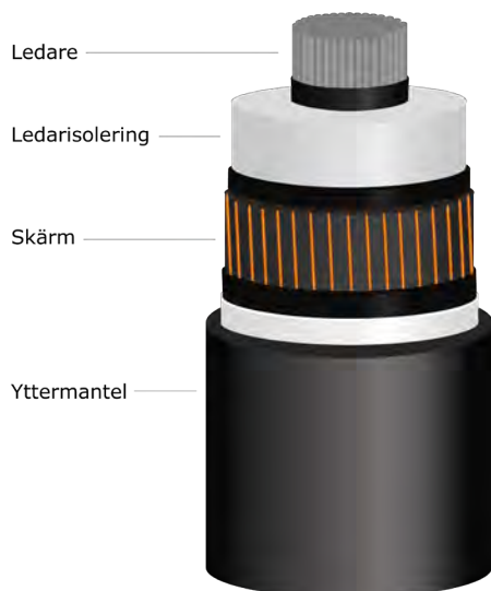
Figur 6. Principskiss av en enfaskabel för 400 kV.
